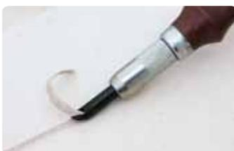
革の折り曲げ時の溝切りに便利な工具。刃は片面のみ。使用後はシン油を塗布しておけば切れ味長持ちします。
