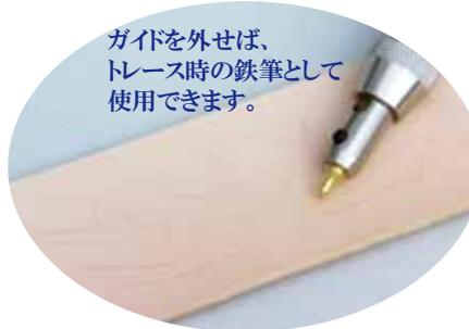
ガイドを外せば、トレース時の鉄筆として使用できます。
