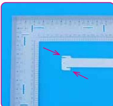
端面ガイドは革の厚みに応じて、爪の厚み1mm・2mmを使い分けます。
