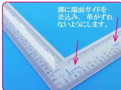
溝に端面ガイドを差込み、革がずれないようにします。
